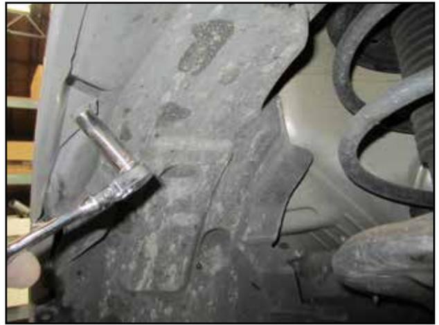
l. Remove the 6MM upper fender bolt.
