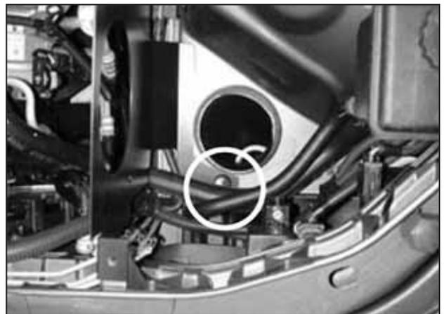
g. Insert the push in tab to secure the bottom mount.
