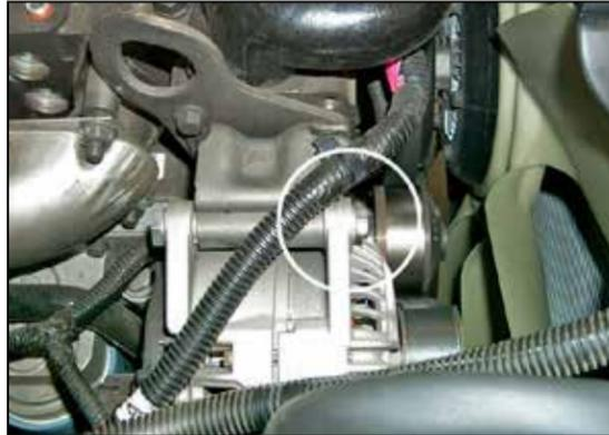
18. Remove the upper alternator bolt.
