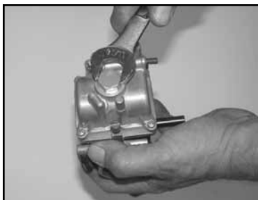
10. Remove the jet holder hex nut.
